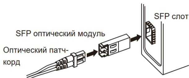
Рис. 12. Подключение оптического модуля SFP
