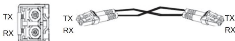
Рис. 11. Кабельное соединение оптического модуля SFP
