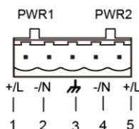
Рис. 19. 5-контактный съемный клеммный блок с шагом 5,08 мм
