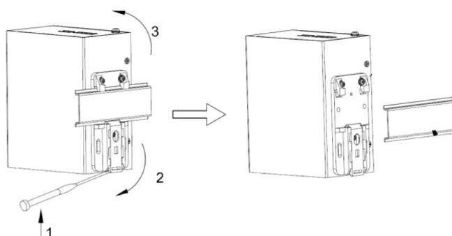
Рис. 5. Демонтаж с DIN рейки
