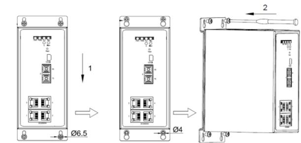
Рис. 6. Монтаж на панель
