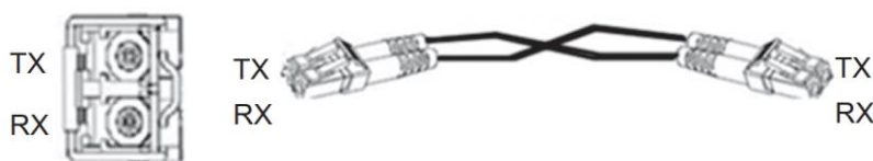
Рисунок 17. Кабельное соединение оптического модуля SFP
