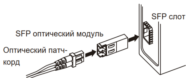
Рисунок 18. Подключение оптического модуля SFP
