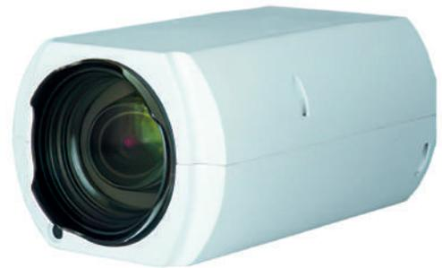
Модель KV-P2028 это 8-мегапиксельная сетевая камера с моторизованным объективом 6.4 – 138.5 мм (кратность 22x), снимающая видео с разрешением 3856x2180 и частотой кадров 30 к/с. Благодаря использованию высокочувствительной матрицы размером 1/1.8", моторизованного варифокального объектива и технологии WDR, камера KV-P2028 позволяет получить детализированное изображение удаленных сцен с разрешением 4K.
